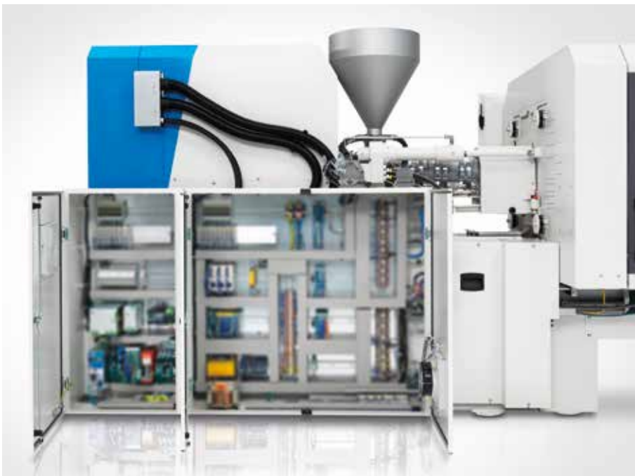
Der Steuerungsschaltschrank ist für viele Optionen vorbereitet.
