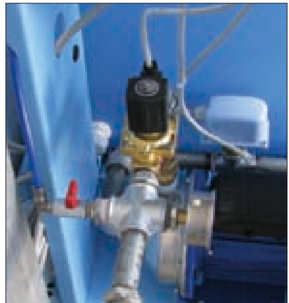
Thermostatic valve with servo control. Valvola termostatica con servocomando.
