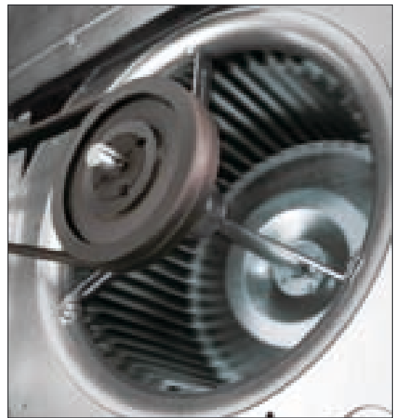
Centrifugal fan. Ventilatore centrifugo.
