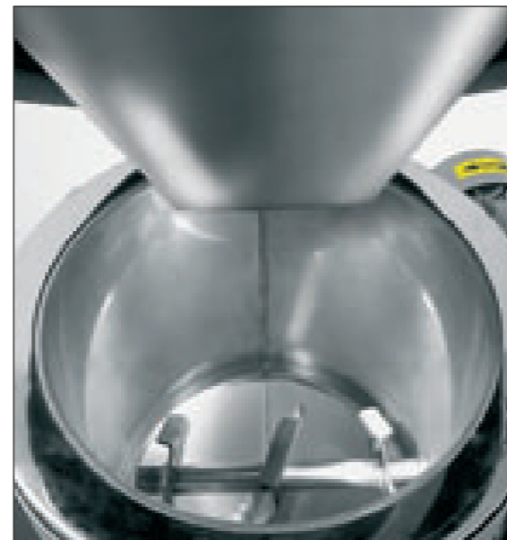
Interior of the hopper with mixer device. Interno della tramoggia con il dispositivo mixer.
